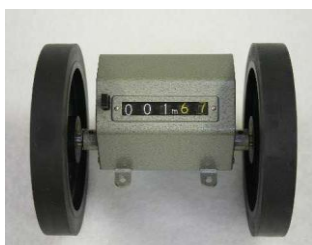
Speciális hosszmérő műszer
